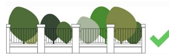
1/3 részben kőlabazat és 2/3 részben áttört kerítés.
